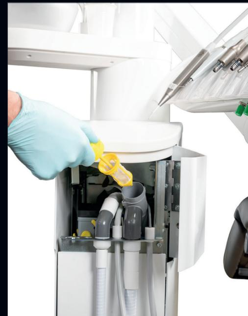
Le filtre de la tubulure d'aspiration à haut volume, est placé derrière un capot à charnières, mais est facilement accessible.
