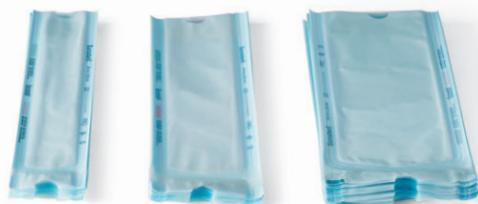
Enveloppes à souder en papier médical blanc à grammage élevé (60 g/m<sup>2</sup>) et film plastique bleu clair double épaisseur en polyester / polypropylène. Trois soudures latérales à canaux imperméables et uniformes pour une protection microbienne supérieure. Dotés d'indicateurs chimiques de passage pour la stérilisation à vapeur d'eau ou à gaz (oxyde d'éthylène). Décollements adaptés sans risque de perte de fibres de papier ou de lacération du film au moment de l'ouverture du sachet.
