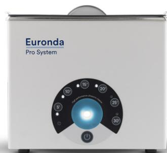
Bac numérique à ultrasons, caractérisé par une température de service constante à 60°C et un temps réglable de 0 à 30 minutes au moyen du contrôleur central rétro-éclairé. Eurosonic® 3D fonctionne par le biais de la technologie Sweep Mode qui distribue de façon homogène les ondes ultrasonores pour un nettoyage plus uniforme. Il est également doté d'un compte à rebours visuel du cycle, grâce aux leds entourant le contrôleur frontal. Les poignées latérales facilitent le déplacement du bac.
