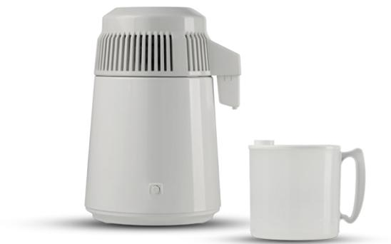
Distillateur d'eau qui permet d'obtenir de l'eau distillée par ébullition et la condensation successive de la vapeur. Il distille 0,7 L d'eau par heure. Capacité 4 litres. Il répond aux tests de sécurité et de compatibilité électromagnétique (2014/108/UE) et à ceux concernant la basse tension (2014/35/UE).
